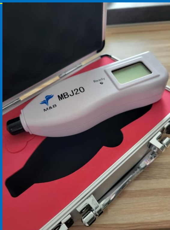
Bilirubinometr – umożliwia badania noworodków w domu pod kątem żółtaczki (bez konieczności wykonywania poboru krwi w ośrodku lub szpitalu)
